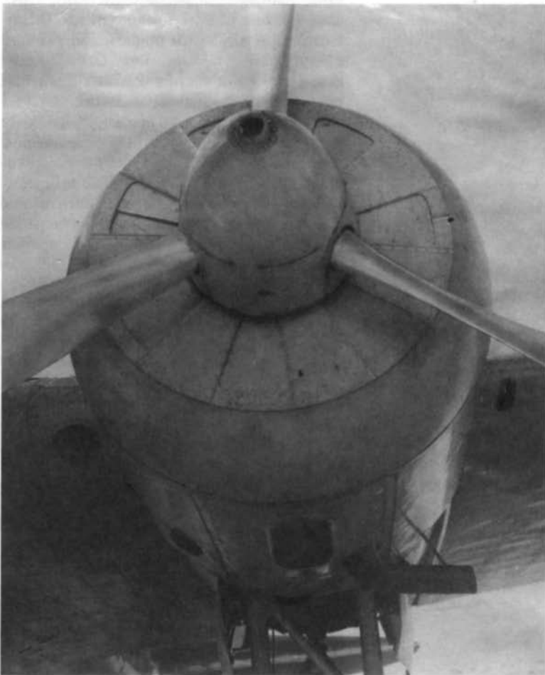
Лобовые жалюзи капота мотора конструкции завода № 39
