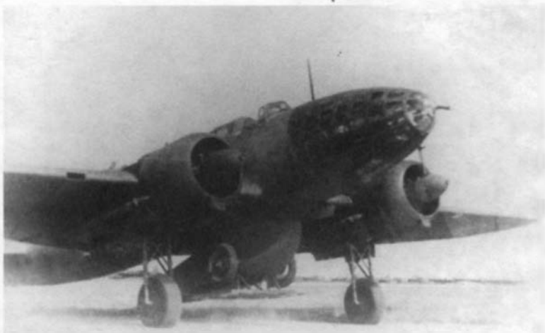
Ил-4 с подвешенной под фюзеляжем 45-мм противотанковой пушкой в обтекателе
