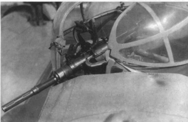
Турель СУ с пулеметом УШ (УША) и прицелом ПТЛ-39А
