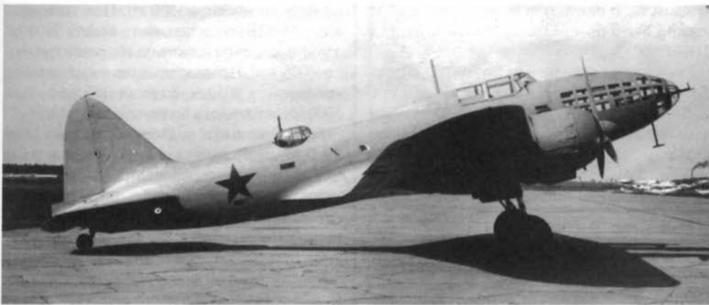
ДБ-3Ф с моторами М-87Б в капотах типа Ф и винтами ВИШ-3
