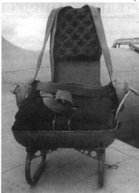
Кресло инструктора с дополнительными подушками, размещавшееся в передней кабине учебной машины
