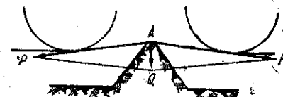
Фиг. 105. Схема перехода гусеничной цепи через гребень.
