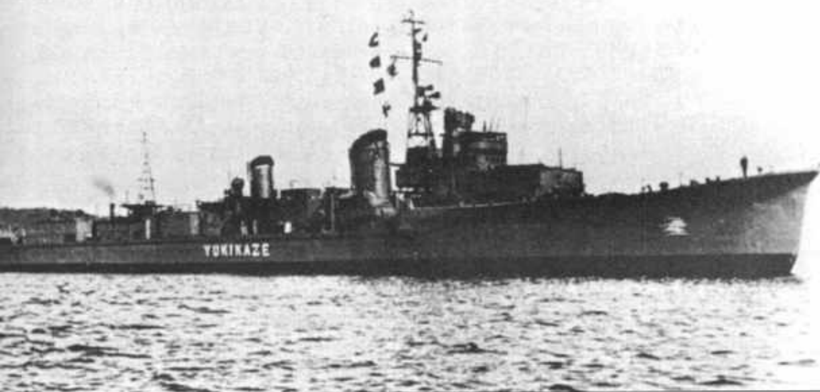
Fot. 11. Nadal w służbie transportowej, ale już ze zdemontowanymi wieżami artylerii głównej.
