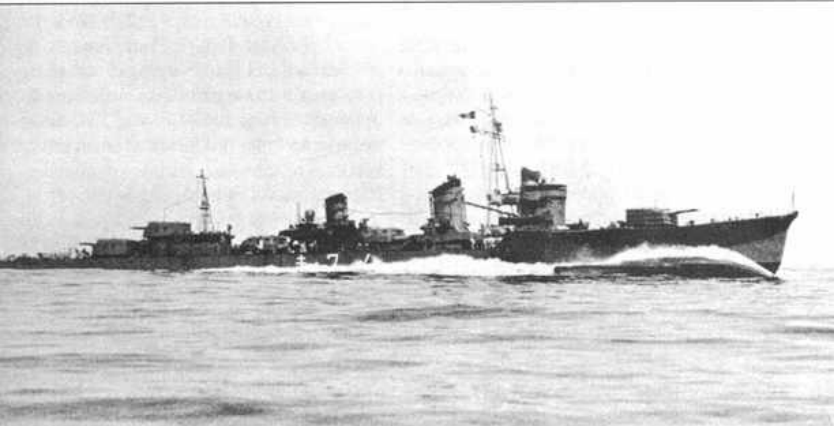
Fot. 13. Niszczyciel NOWAKI w marszu z pełną prędkością 35,1 węzła. Fotografię wykonano w kwietniu 1941 roku na próbach odbiorczych.
