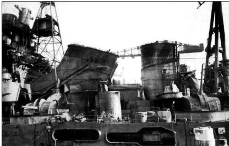
Повреждения центральной части крейсера «Майя» после боя у Гуадалканала 15 ноября 1942 г.
