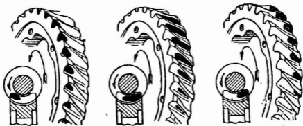
Фиг. 32. Регулировка червячного зацепления.
