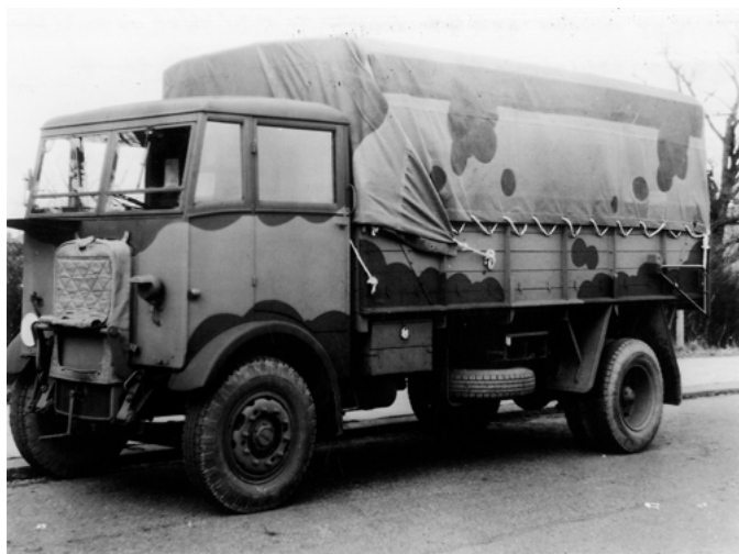
Maudslay Militant 4x2 G.S. в камуфляже М.Т.Р.46/4А в базовом цвете S.C.C.2 (коричневый) и с рисунком S.C.C.1A (темно-коричневый), с окрашенным брезентом S.C.C.2. Правильно оформленные темные ящики, брызговики и колеса. Кузов был изготовлен на каретном заводе и позже прикреплен к кабине/шасси. Обратите внимание на различия в камуфляже кабины и кузова.
