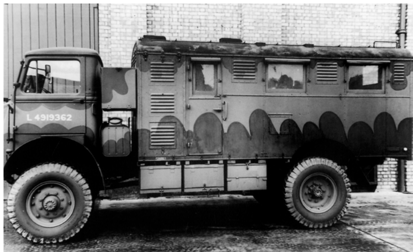
Кузов Bedford QLR с радиосвязью. Схема М.Т.Р.46/4А в цвете S.C.C.2 (коричневый) с узором S.C.C.1A (темно-коричневый). Кабина окрашена на заводе, кузов добавлен позже в другом депо и окрашен в другом стиле, с более светлой краской, но без ниш под кузовом.
